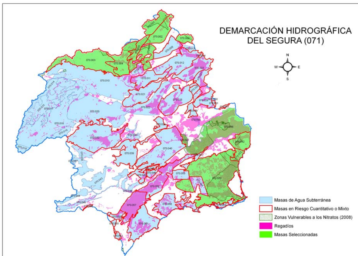
Figura 4.- Selección de MASb por la aplicación del Criterio Zonas Vulnerables a los Nitratos en la Demarcación Hidrográfica del Segura
